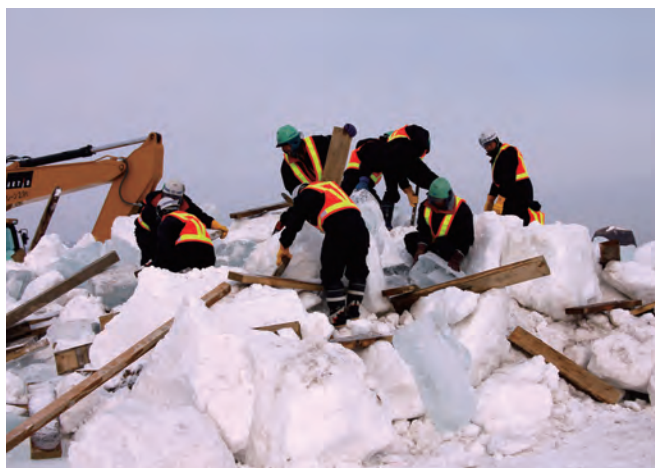
流氷とがれきが混ざった漂流物の撤去実験
